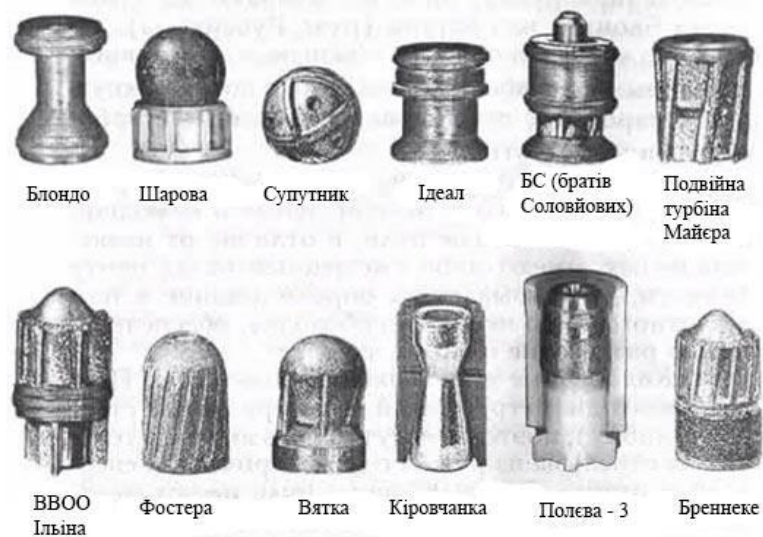
Рис. 3 Типи куль для гладкоствольних рушниць
